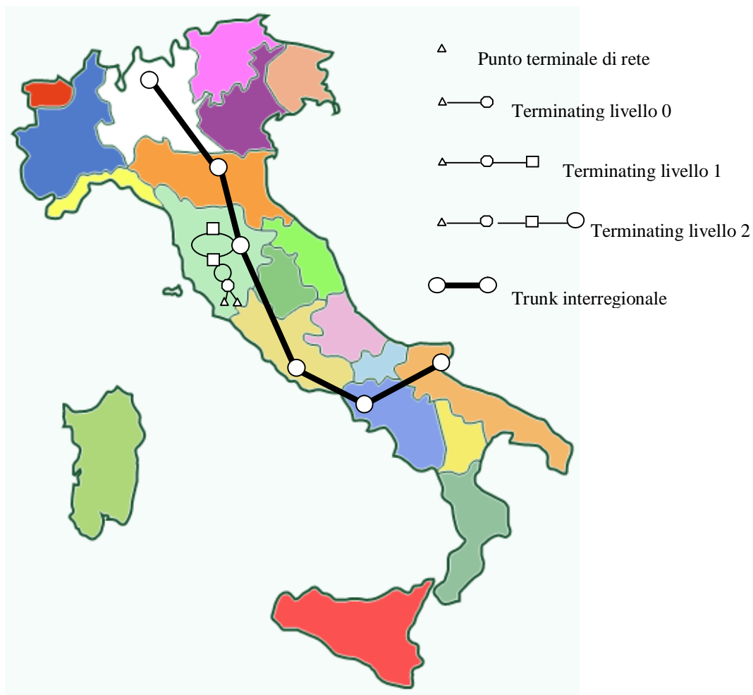
Figura 2 - Esempio di segmenti trunk nella dorsale di rete di trasporto di lunga distanza
